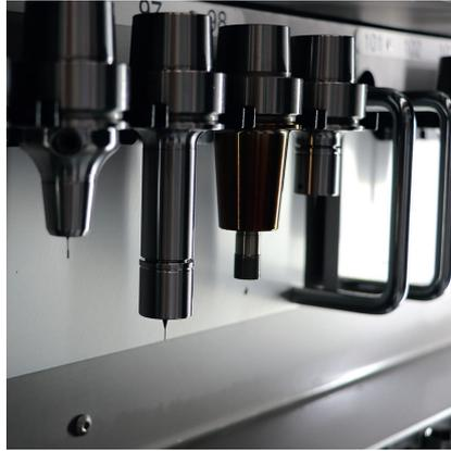
6 Kleinste und feinste Fräser – wie hier im Werkzeugmagazin der Kern Micro HD – sind für die hochpräzise Bearbeitung von Kleinbauteilen bei Fuchshofer oftmals unentbehrlich © Kern Microtechnik
