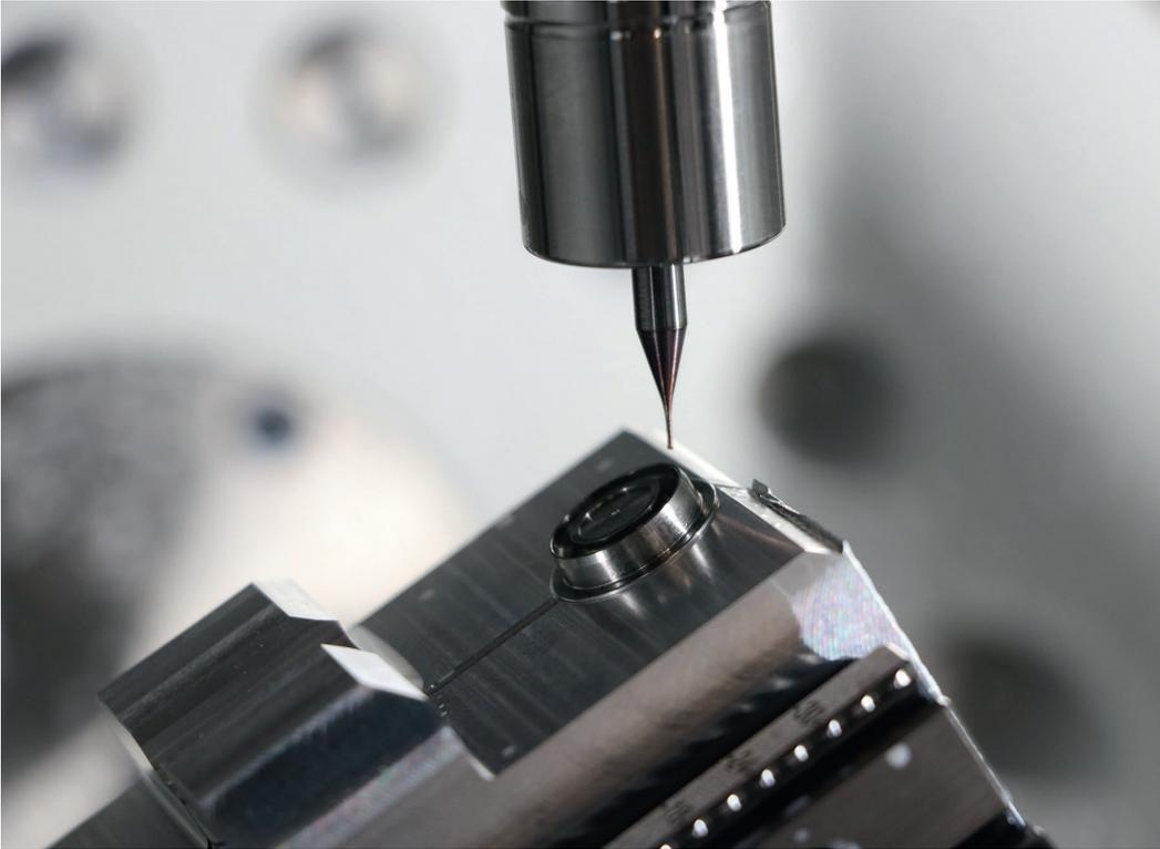
1 5-Achs-Hochpräzisionsbearbeitung: Entscheidend für die Präzision und Produktivität der Kern Micro HD sind neben den hochleistungsfähigen linearer Direktantrieben vor allem die einzigartige Mikrospalt-Hydrostatik und das innovative Temperaturmanagement
